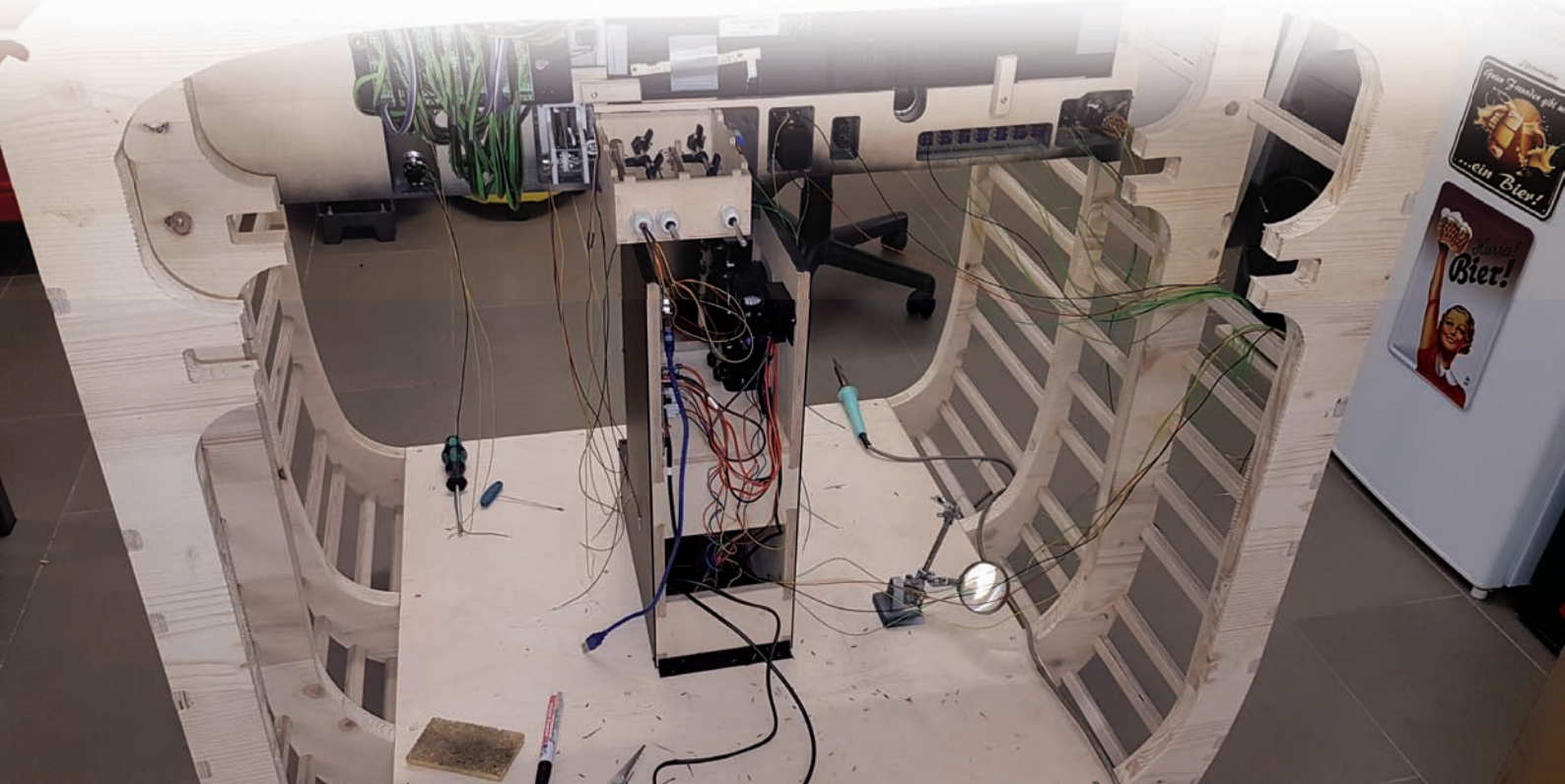
Der Holzrahmen des Kernbereichs des Cockpits mit Aufnahmen für das Panel und ersten verlegten Kabeln.
