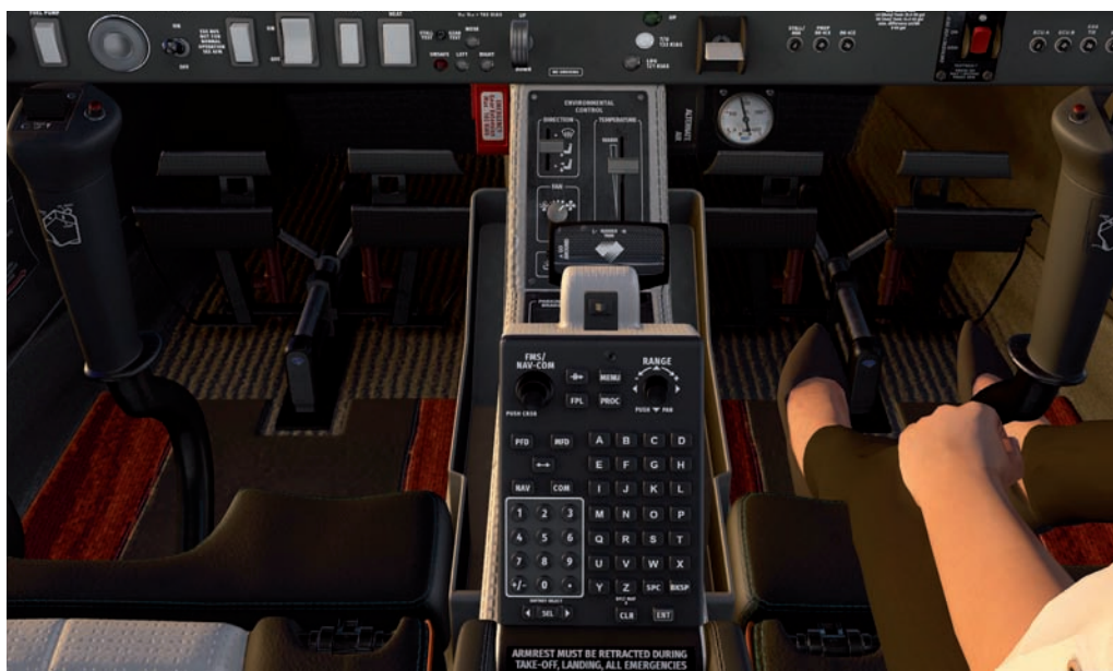
Das Keypad für das FFS wird aus der Armlehne herausgeklappt.
