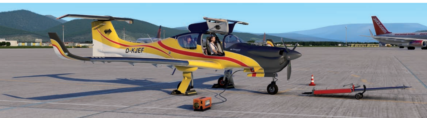
Eine externe Batterie zur Stromversorgung, Warnkegel und eine Schleppstange gehören zu den „Äußerlichkeiten“ am Boden.
