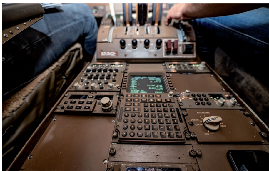
Das Pedestal der B744 mit der dritten Control and Display Unit (CDU) und COM-Geräten.
