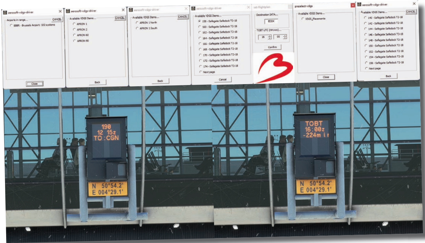
Parkposition 158 mit Blick ins Terminal: Nach Eingabe des Flugziels wird auf dem VDGS der ICAO-Code angezeigt und die Zeit bis zum Abflug.
