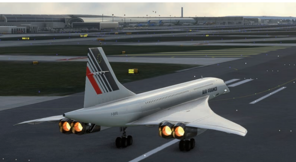
Voller Schub: Die Concorde nimmt mit den Nachbrennern der Olympus-Triebwerke schnell Fahrt auf.
