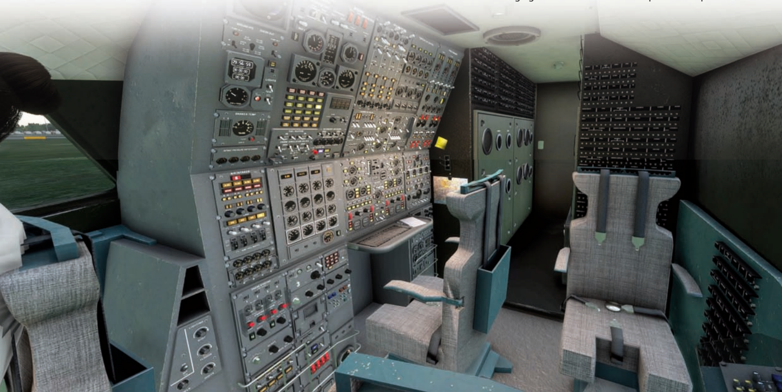
Das auf den ersten Blick verwirrende Panel des Flugingenieurs hinter dem Arbeitsplatz des Copiloten.
