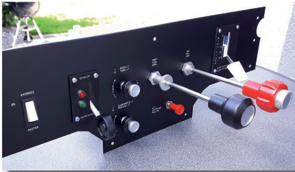
Die Konsole mit Hauptschaltern, Schub-, Gemisch-, Klappen- und Fahrwerkhebel.
